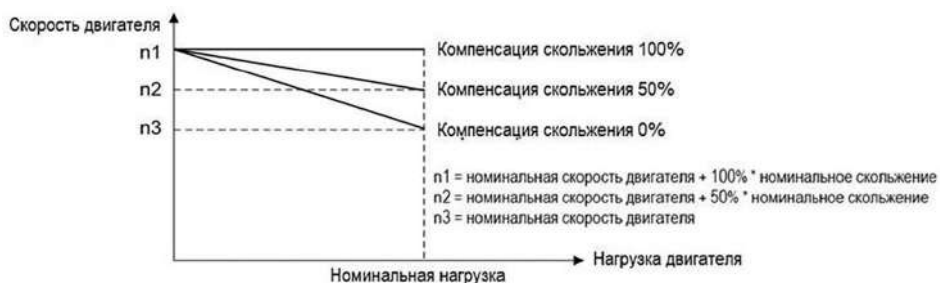
Компенсация скольжения в режиме вращения двигателя
